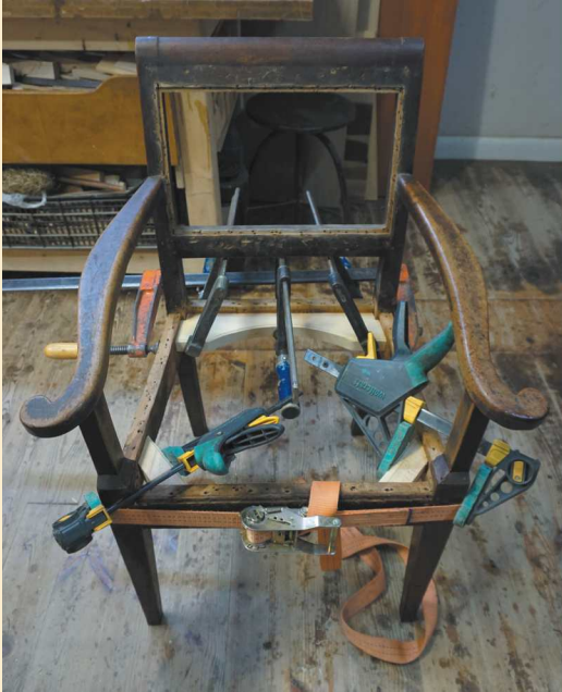
1. Klejenie poluzowanej konstrukcji oraz wklejanie dodatkowych, dorobionych wzmocnień.
