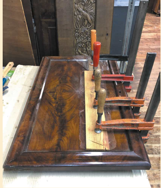
2. Naprawa pękniętej płyciny drzwi.
