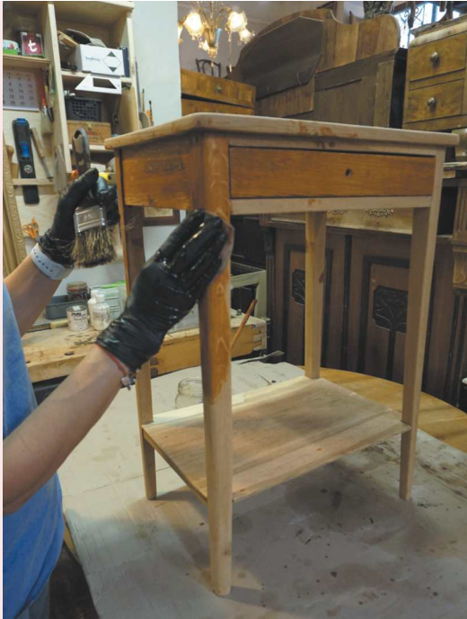
10. Gruntowanie drewna olejem wazelinowym pod politurę.
