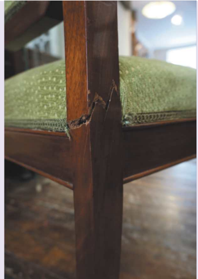
3. Poprzeczne złamanie nogi oparciowej krzesła, najprawdopodobniej kwalifikujące cały element do rekonstrukcji.
