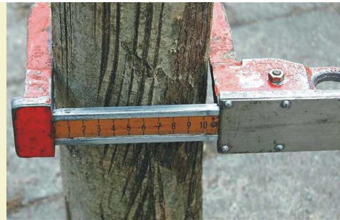
5. Pomiary średnicy drzewa za pomocą klupy (fot. G.Elsner, https://commons.wikimedia.org ).
