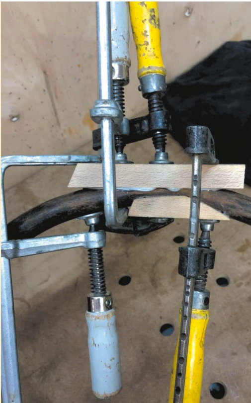
8. Doklejanie bukowych wstawek do uszkodzonego elementu krzesła.
