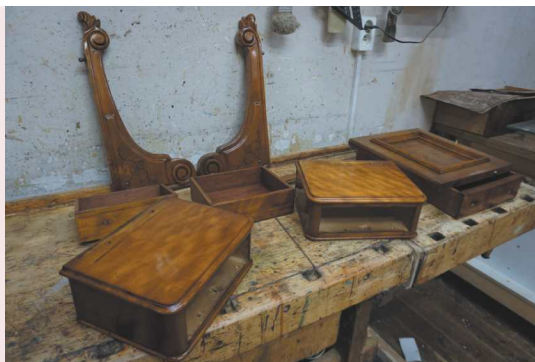
4. Montaż elementów toaletki po zakończonej konserwacji.
