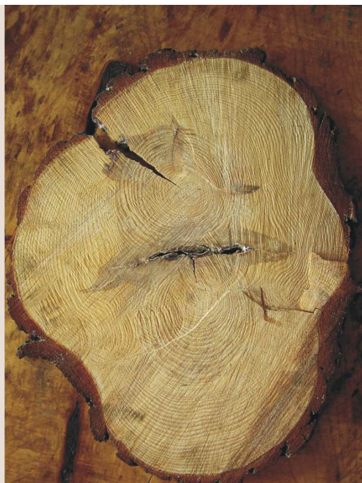
28. Dwurdzenność z zakorkiem na sośnie pospolitej (fot. Beentree, https://commons.wikimedia.org ).
