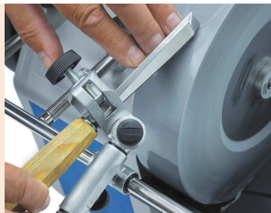
13. Ostrzenie dłuta prostego na szlifierce przy użyciu specjalnego uchwytu ( www.dluta.pl ).
