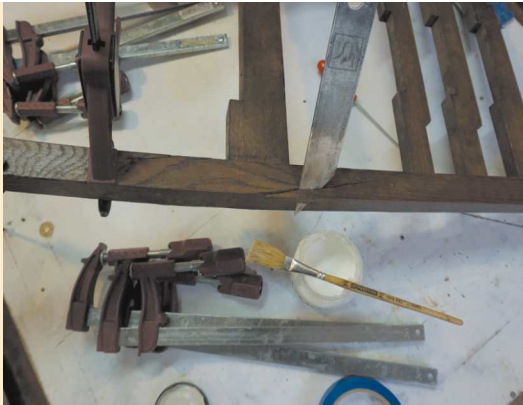
3. Naprawa pęknięć drewna za pomocą kleju polioctanowinylowego oraz ścisków stolarskich.
