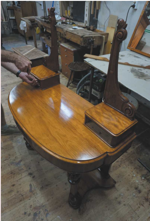
5. Montaż przy pomocy oryginalnie zachowanych wkrętów elementów toaletki.
