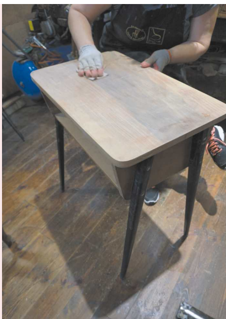
3. Wygładzanie powierzchni stolika przy pomocy drobnoziarnistego papieru pod politurę szelakową.
