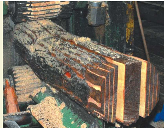
10. Widok przetarcia jednokrotnego. W środku materiał główny (pryzma), po bokach deski nieobrzynane jako materiał boczny.
