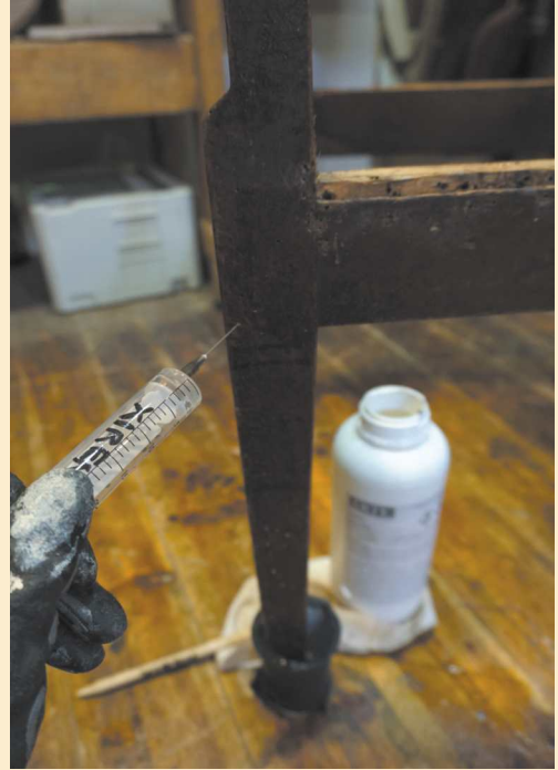
15. Aplikowanie płynu na szkodniki za pomocą strzykawki.
