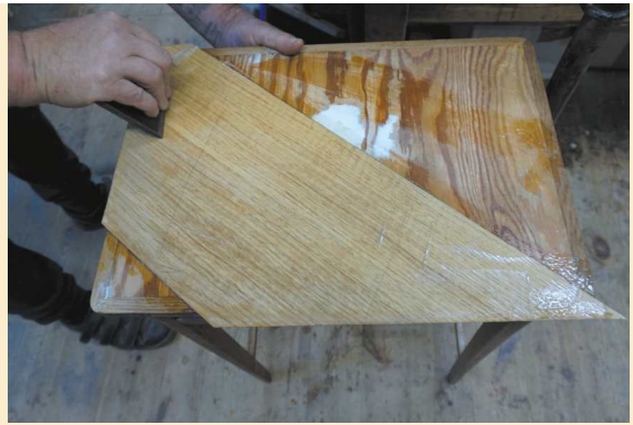
19. Przyklejanie tzw. blintu, czyli ślepej (pod)okleiny
