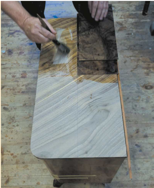
16. Klejenie tradycyjne przy pomocy kleju glutynowego – składanie okleiny z czterech formatek (okleina orzechowa).
