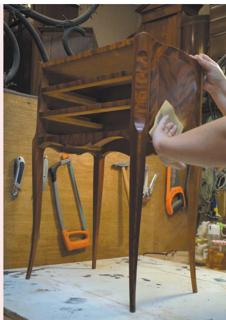
4. Wygładzanie powierzchni stolika pod politurę szelakową (matowienie).
