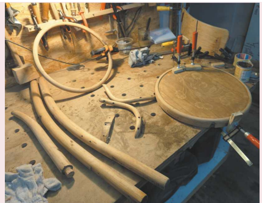
3. Zdemontowane gięte krzesło w trakcie prac naprawczych.
