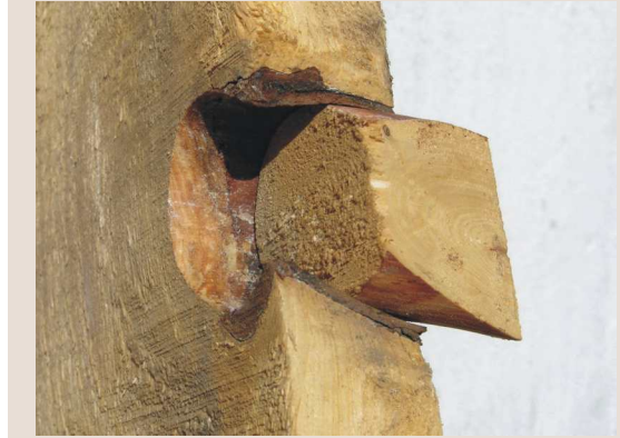
29. Sęk niezrośnięty (wypadający) (fot. Beentree, https://commons.wikimedia.org ).
