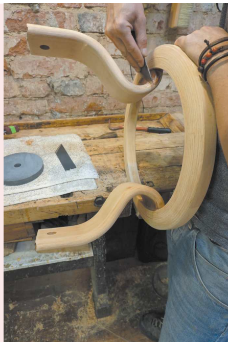
2. Usuwanie starej powłoki lakierniczej przy pomocy skrobaków i cyklin.
